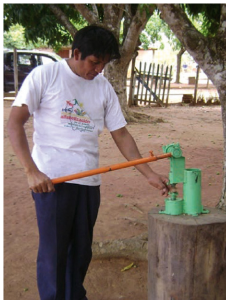
Foto 1. Las máquinas quebradoras elaboradas específicamente para extraer la semilla de almendra permiten reducir la dureza del trabajo, haciéndolo más accesible a los jóvenes y ancianos. Foto U. Rémillard-Fuente: Vennetier et al., 2012
